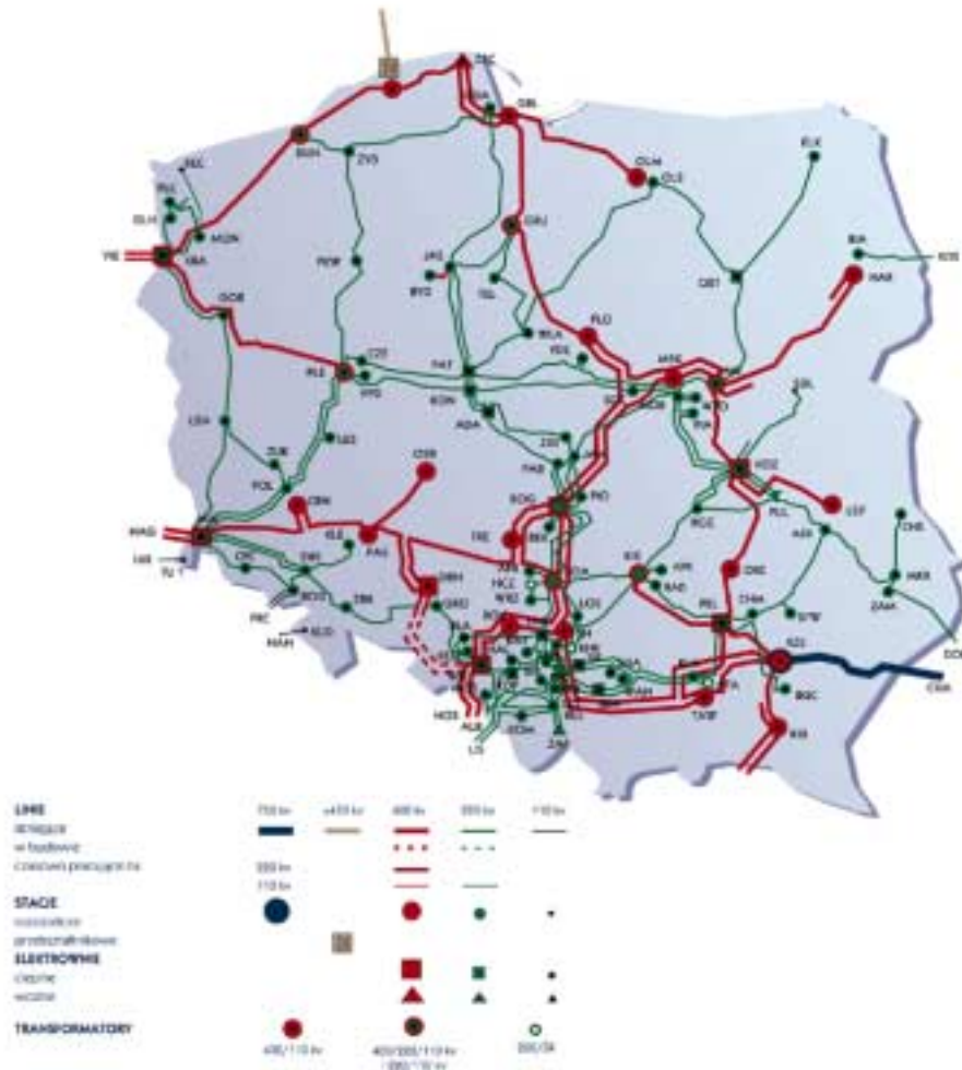
Rys. 3 System energetyczny WN Polski, za PSE S.A.
